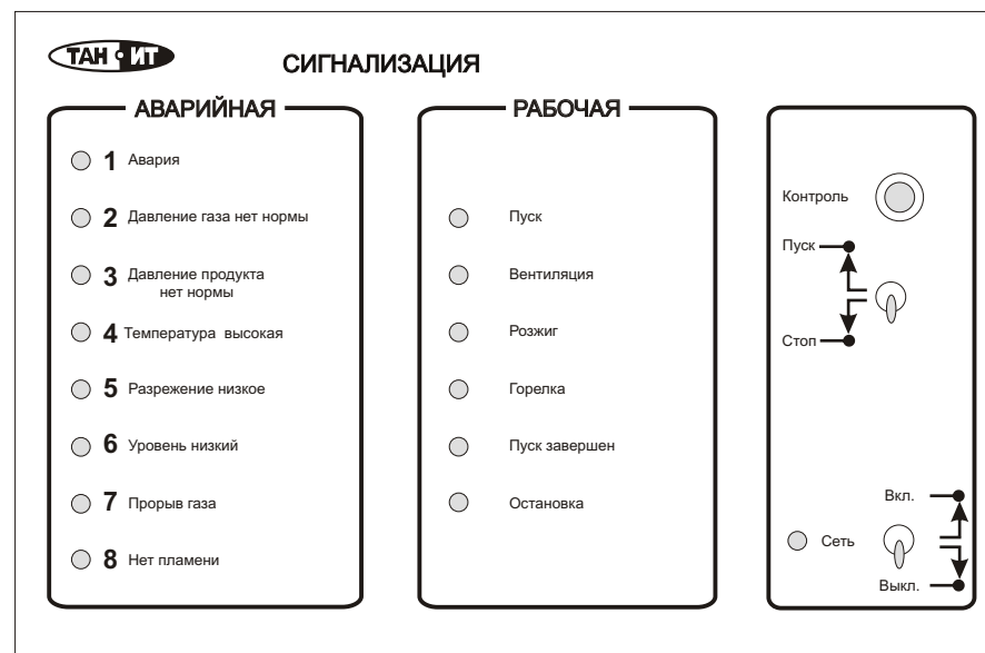
Рис. 2 Передняя панель блока БУК-5 ПГ.1
